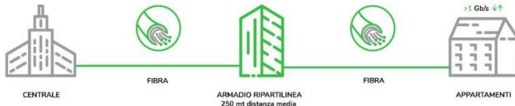
C'è quella in rame (**R**) con il bollino rosso, quella mista fibra/rame (**FR**) con il bollino giallo e poi c'è la FTTH (**F**) con il bollino verde, l'unica integralmente in fibra ottica fin dentro casa, che offre fino a 1 Gigabit al secondo e il massimo della performance su tutti i devices.
