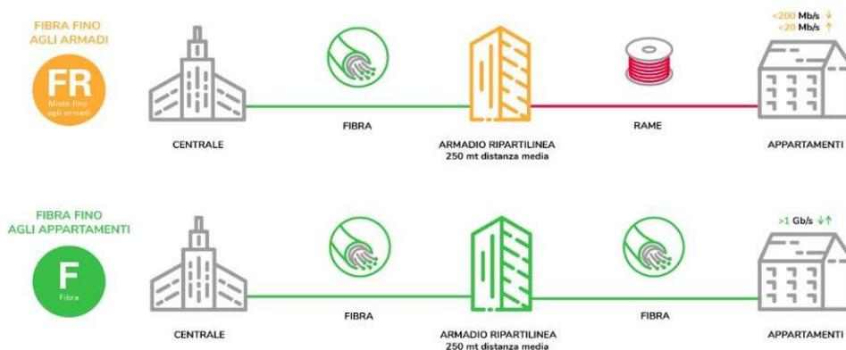
C'è quella in rame (**R**) con il bollino rosso, quella mista fibra/rame (**FR**) con il bollino giallo e poi c'è la **FTTH (F) con il bollino verde, l'unica integralmente in fibra ottica** fin dentro casa, che offre fino a 1 Gigabit al secondo e il massimo della performance su tutti i devices.
